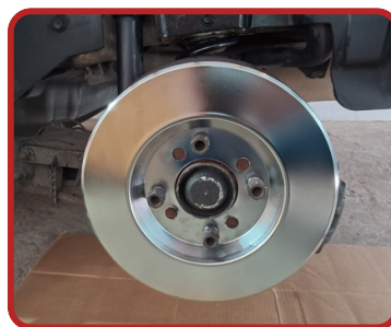
Instalação na roda traseira em veículos que não possuem freio a disco.
